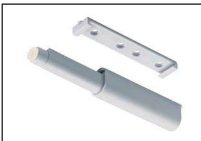
PUSH-PULL Sistema con pistoncino premi apri applicato al fianco (cappello o basamento per ante ribalta) che permette l'apertura mediante una spinta su essa. L'anta è dotata di piastrina magnetica per evitare lo sgancio accidentale del pistoncino. Per un funzionamento corretto consigliamo una regolazione tra i 3 ed i 5 mm di gioco tra anta e struttura del contenitore.
